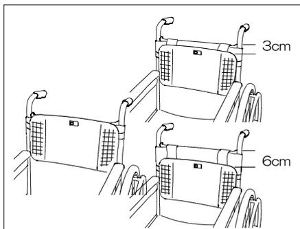
①ベース部を取り付ける高さを決めます。背シート上端と3cm下方、6cm下方の三段階に高さを調整できます。
