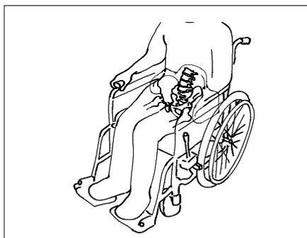
②ご利用者の腰が、バックサポートにピッタリ接する位置まで深く座り、サイドサポートが左右対称に骨盤を囲むよう腰の位置を調整してください。
